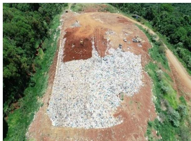
**Figura 33** - Vala em operação junto ao Aterro Sanitário de Pato Branco. Fonte: Equipe Ideal, data da imagem 30/11/2022.
