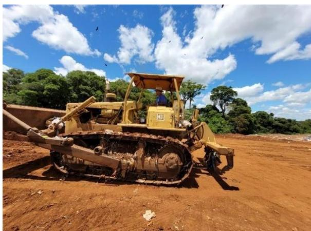
**Figura 6** - Trator de esteira utilizado para nivelamento dos resíduos na célula do aterro. Fonte: Ideal Assessoria Ambiental, 2022.
