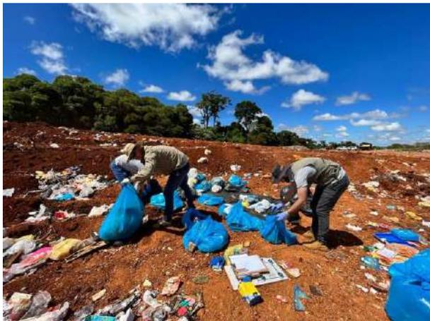
**Figura 10** - Análise gravimétrica dos resíduos sólidos e dos rejeitos destinados ao aterro sanitário de Pato Branco. A Análise foi realizada no local do aterro. Fonte: Ideal Assessoria Ambiental, novembro 2022.
