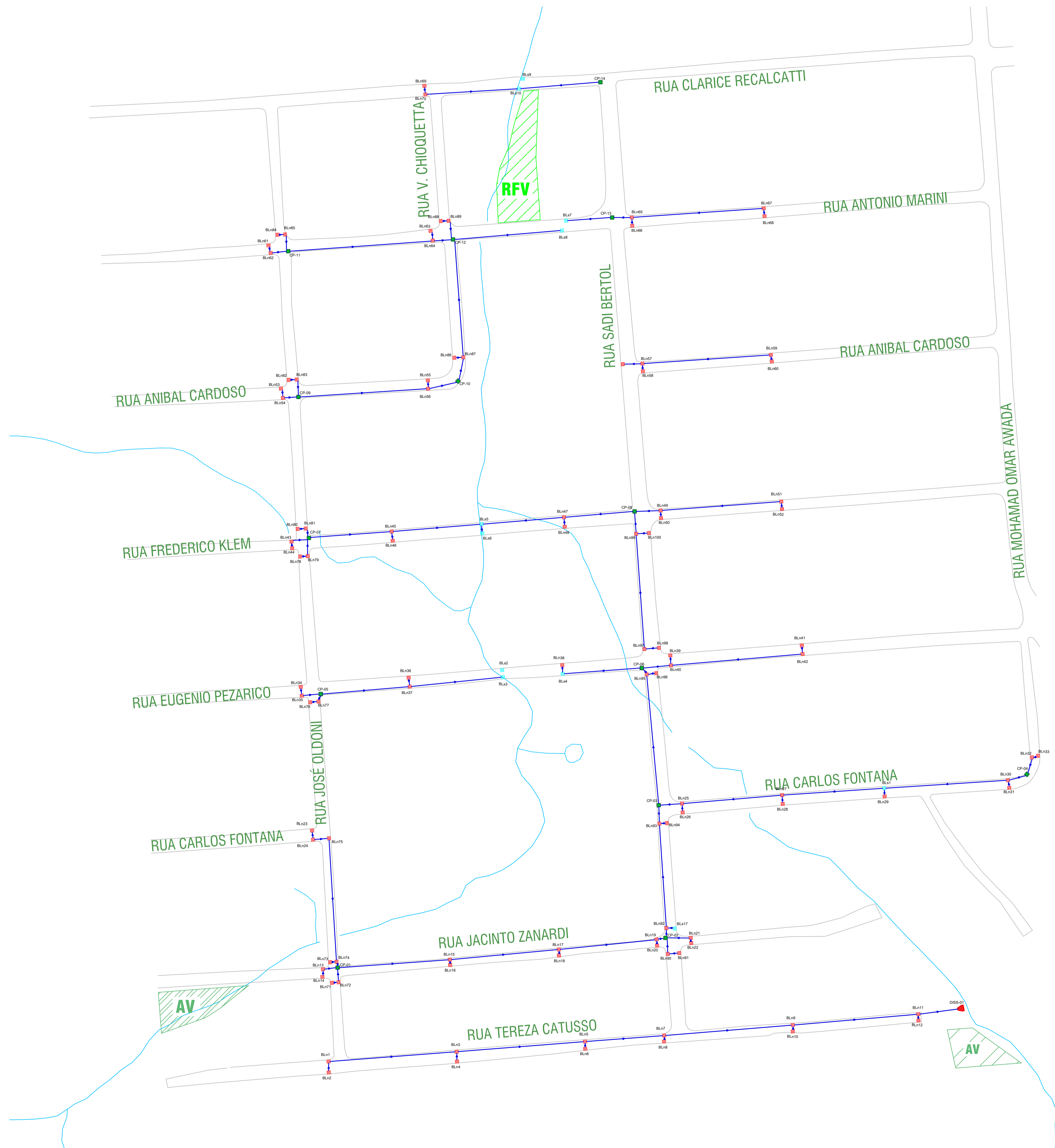
PLANTA BAIXA - GALERIAS DE ÁGUA PLUVIAL BAIRRO SÃO JOÃO Esc. 1/1000
