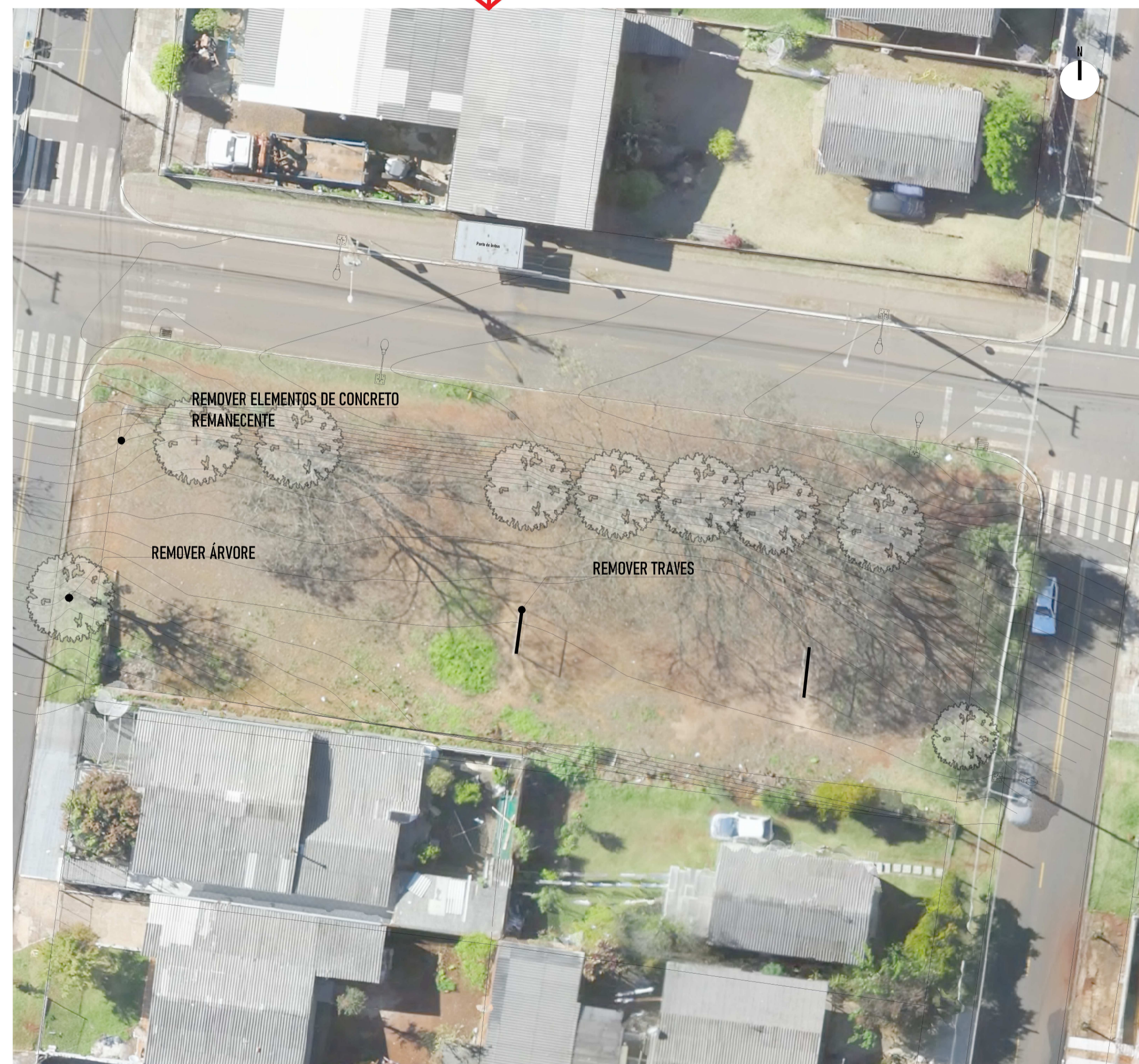
PLANTA DE DEMOLIÇÃO E CURVAS ORIGINAIS ESC:1/250
