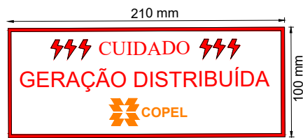
DETALHE 3 - Placa de advertência a ser instalada junto ao quadro de medição.
