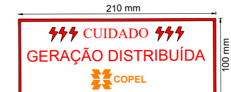
DETALHE 3 - Placa de advertência a ser instalada junto ao quadro de medição.
