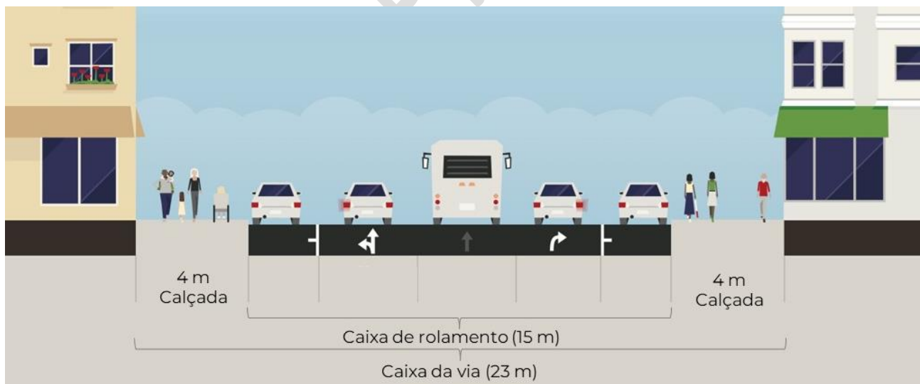
Figura 11: Perfil viário de Via Arterial
