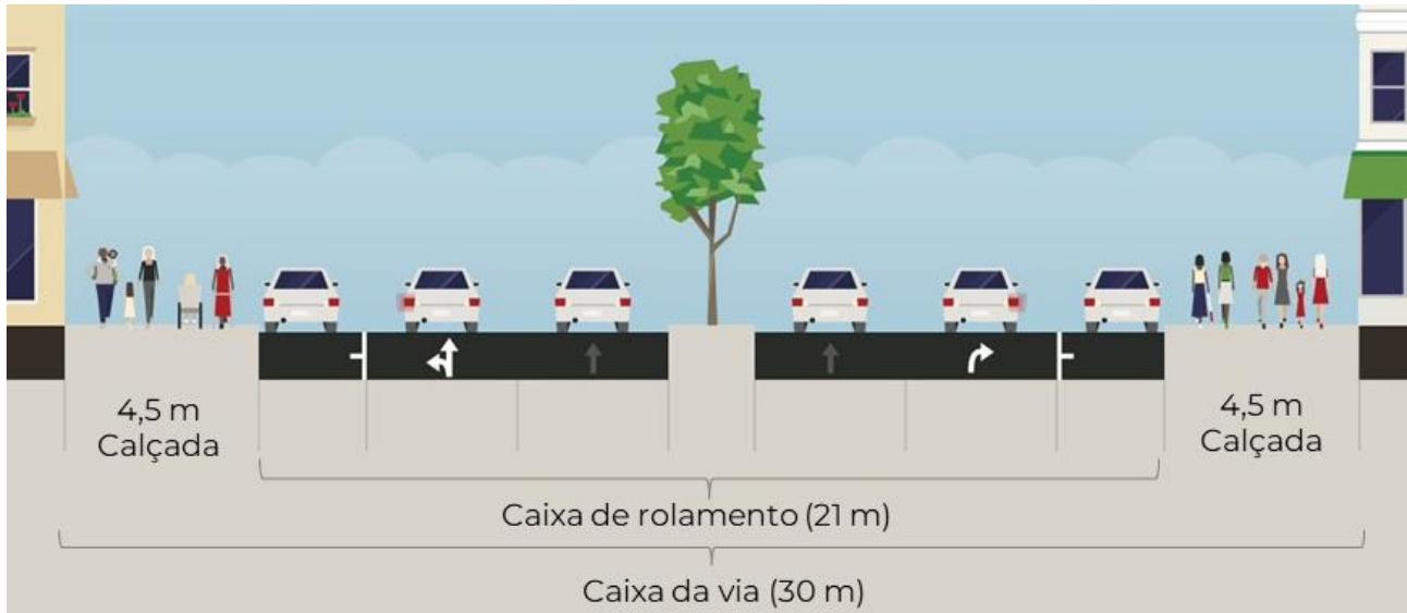
Figura 10: Perfil viário de Via Perimetral
