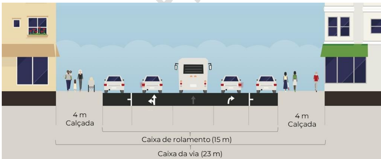
Figura 11: Perfil viário de Via Arterial
