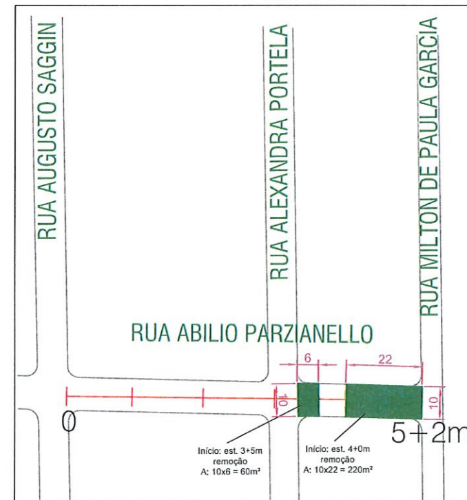
PAVIMENTAÇÃO (REFORÇO) - RUA ABÍLIO PARZIANELLO TRECHO 2 Esc. 1/1000
