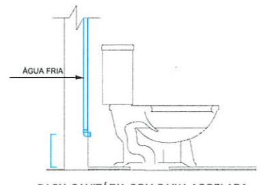
BACIA SANITÁRIA COM CAIXA ACOPLADA Sem escala
