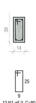
SEÇÃO A-A Esc 1:25
