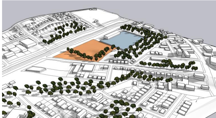
Figura 29 -Simulação Insolação e sombreamento Solstício de Inverno às 09h.
