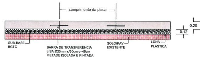
DETALHE 02PR - CORTE LONGITUDINAL
