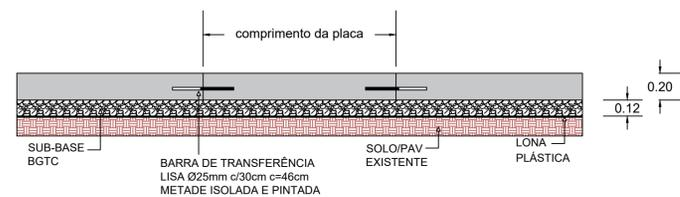
**DETALHE 02PR - CORTE LONGITUDINAL**
