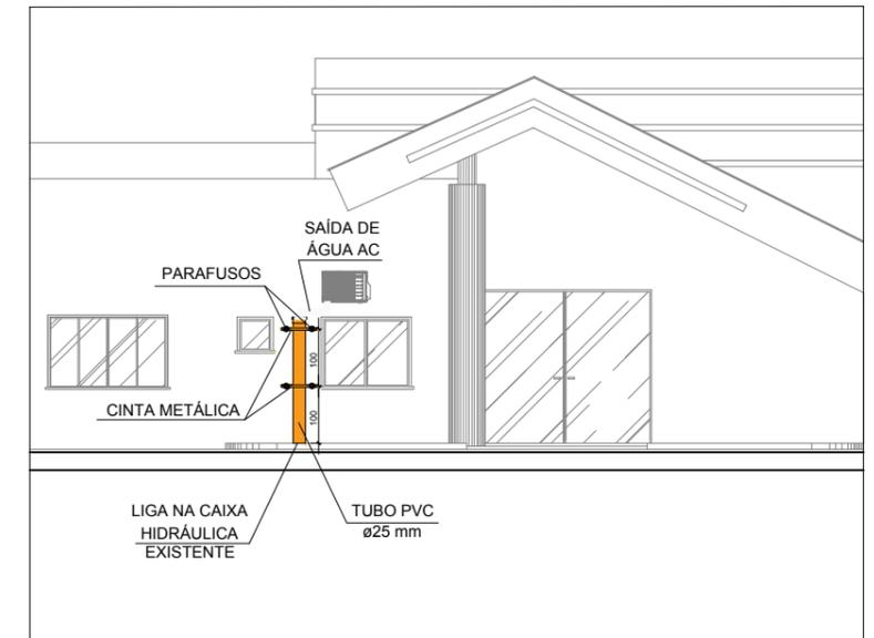
DETALHE-FIXAÇÃO DUTO SEM ESCALA
