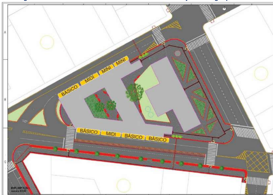
Figura 162 - Planta baixa do Terminal Urbano com localização das vagas para ônibus
