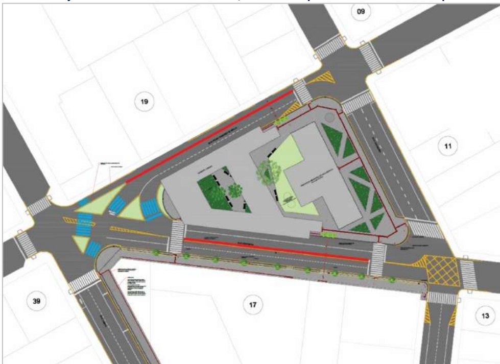
Figura 168 - Projeto do novo Terminal Urbano, com destaque em vermelho e azul para alterações
