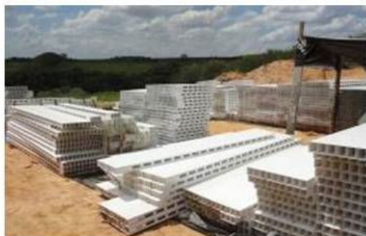
Figura 13 – Painéis de PVC pré-moldados na fábrica
