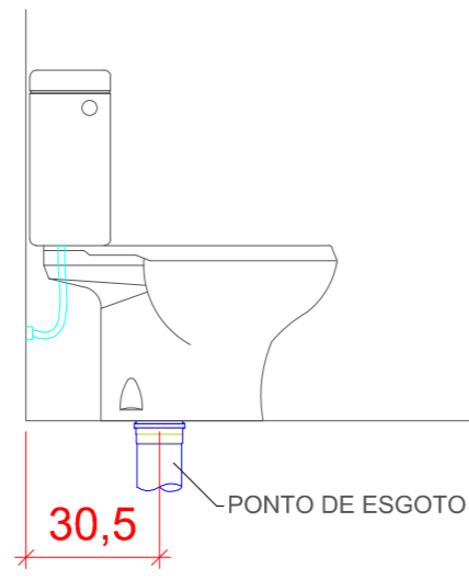
DETALHE VASO SANITÁRIO SEM ESCALA
