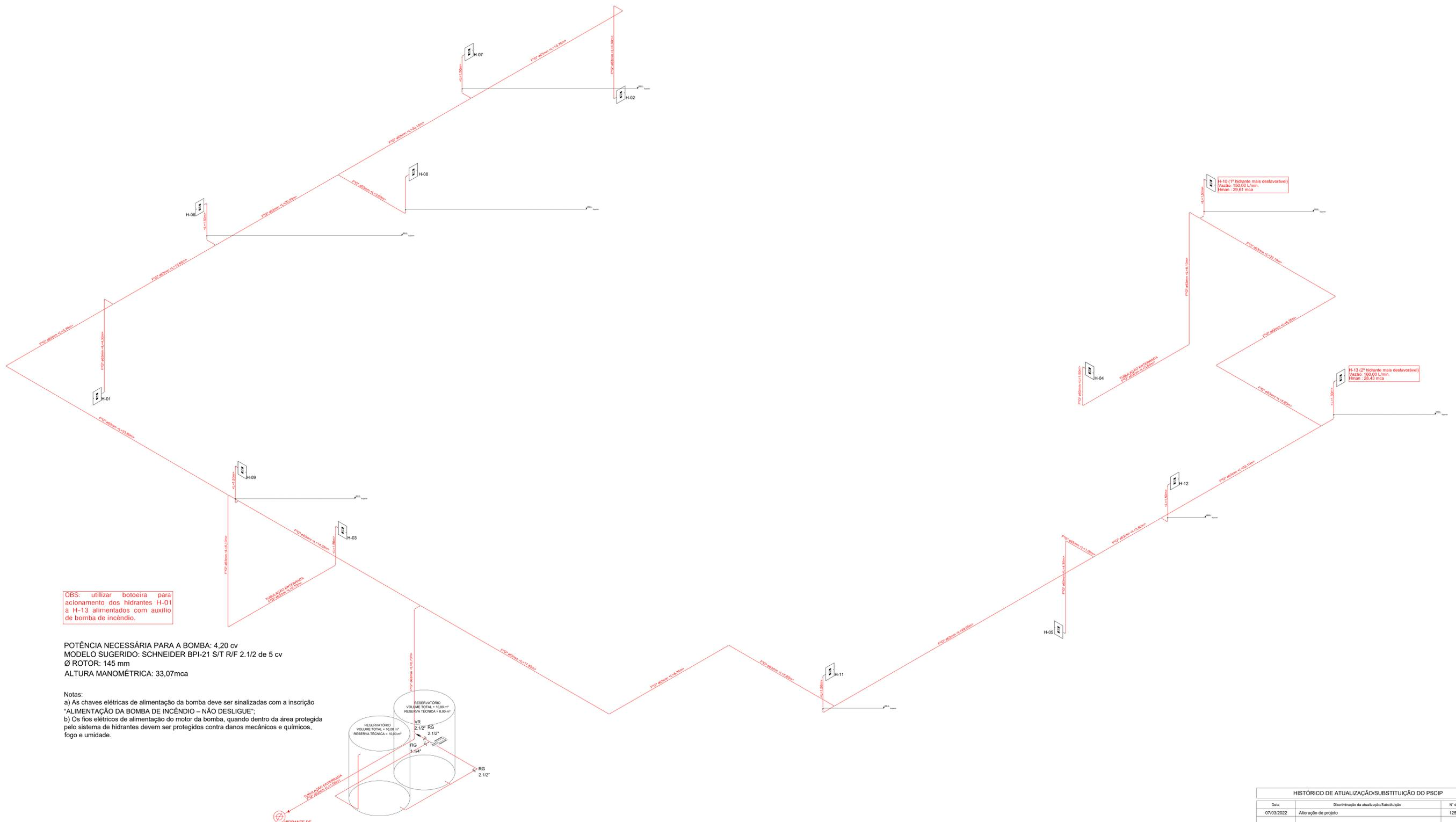
OBS: utilizar botoeira para acionamento dos hidrantes H-01 à H-13 alimentados com auxílio de bomba de incêndio.
