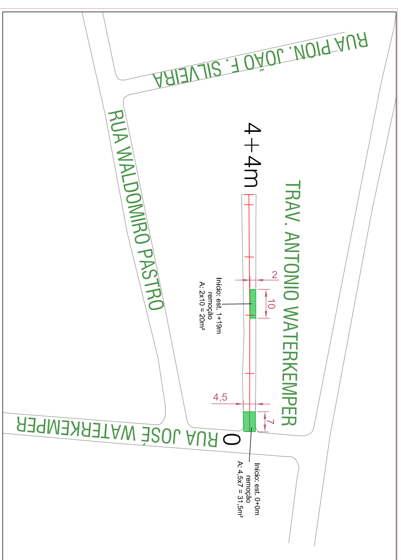
PAVIMENTAÇÃO (REFORÇO) - TRAVESSA ANTONIO WATERKEMPER Esc. 1/750
