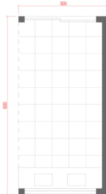
A tipologia modular 05 consiste em 01 módulo de 6x3 metros e 3,00 metros de altura, com pé direito interno de 2,75 metros, com uma parte fechada (canto) e uma parte aberta para circulação, sendo considerados 04 pontos de tomadas, 01 interruptor duplo e 01 ponto elétrico e sistema de coleta (drenos) para aparelho de ar-condicionado tipo Split, distribuídos conforme necessidade.
