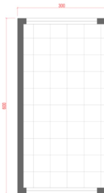
A tipologia modular 01 consiste em 01 módulo de 6x3 metros e 3,00 metros de altura, com pé direito interno de 2,75 metros, três lados fechados e um aberto, sendo considerados 02 pontos de tomadas, distribuídos conforme necessidade.
