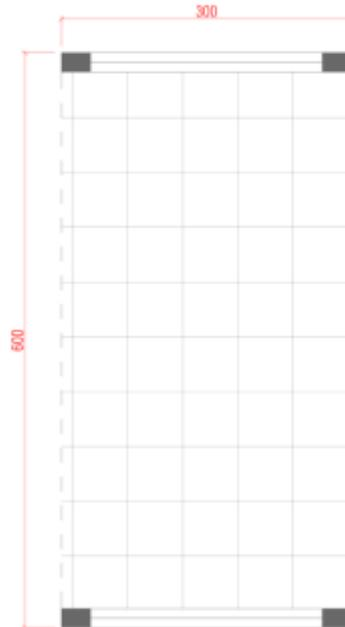
A tipologia modular 02 consiste em 01 módulo de 6x3 metros e 3,00 metros de altura, com pé direito interno de 2,75 metros, dois lados fechados e dois abertos, sendo considerados 02 pontos de tomadas, distribuídos conforme necessidade e 01 ponto elétrico e sistema de coleta (drenos) para aparelho de ar-condicionado tipo Split.
