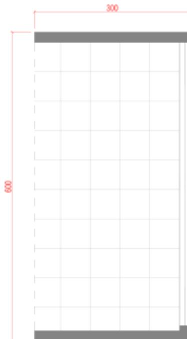
A tipologia modular 11 consiste em 01 módulo de 6x3 metros e 3,00 metros de altura, com pé direito interno de 2,75 metros, três lados fechados e um aberto, sendo considerados 02 pontos de tomadas, distribuídos conforme necessidade.
