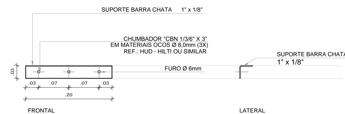
5 DETALHE 02 - CANTONEIRA METÁLICA ESCALA 1/5
