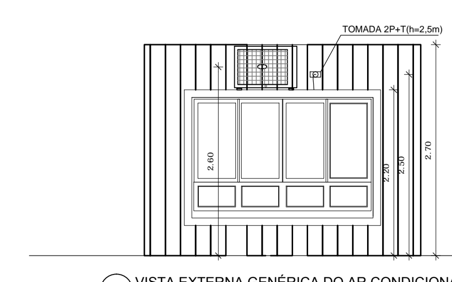
4 VISTA EXTERNA GENÉRICA DO AR CONDICIONADO 1:50
