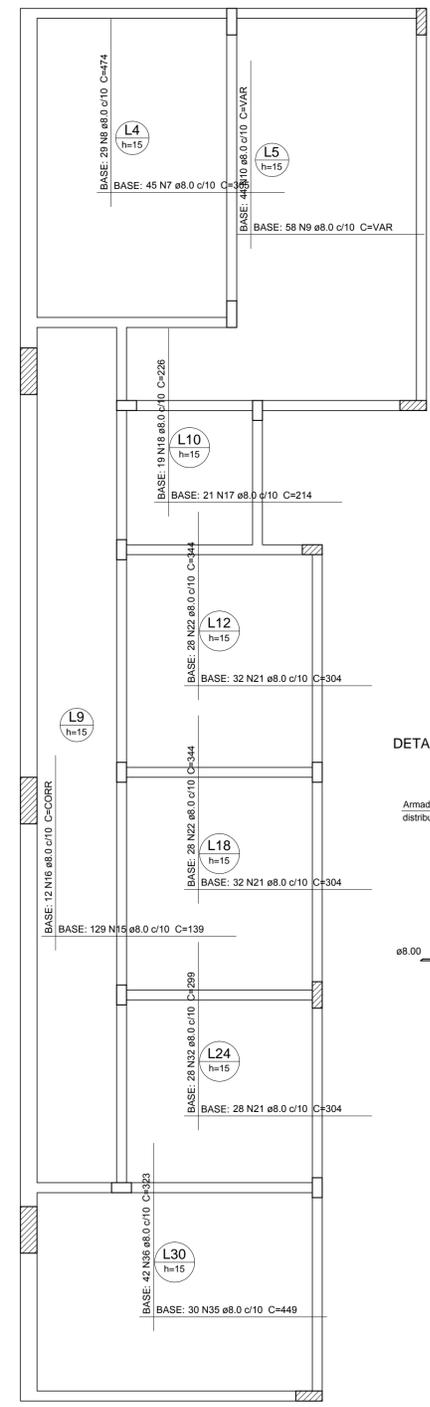
DETALHE DA ARMADURA DE MALHA BASE
