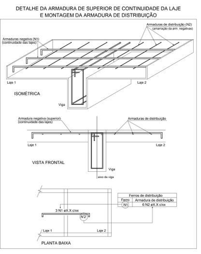
Armação negativa das lajes do pavimento 1º Pavimento escala 1:50
